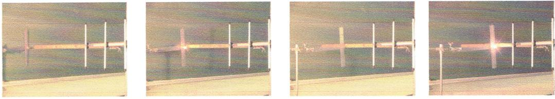
黒板に向け送信してきた定常波を自作ダイポールアンテナで調べます。腹の部分に持ってくると明るく光ります。この実験では節と節の間が約 34cm でした。計算すると振動数は  $4.4 \times 10^2$  MHz となり、ほぼ満足な値が出ました。
